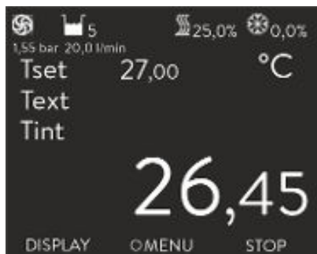
Fig. 45: Finestra di base Integral XT e Integral P con regolazione di flusso
