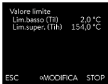
Fig. 39: Definizione dei valori limite di temperatura
