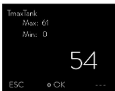
Fig. 38: Immettere T_{max} (in questo caso T_{maxTank} )
