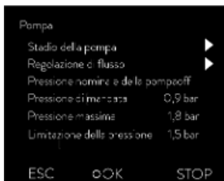
Fig. 43: Menu Pompa per Integral XT FC
